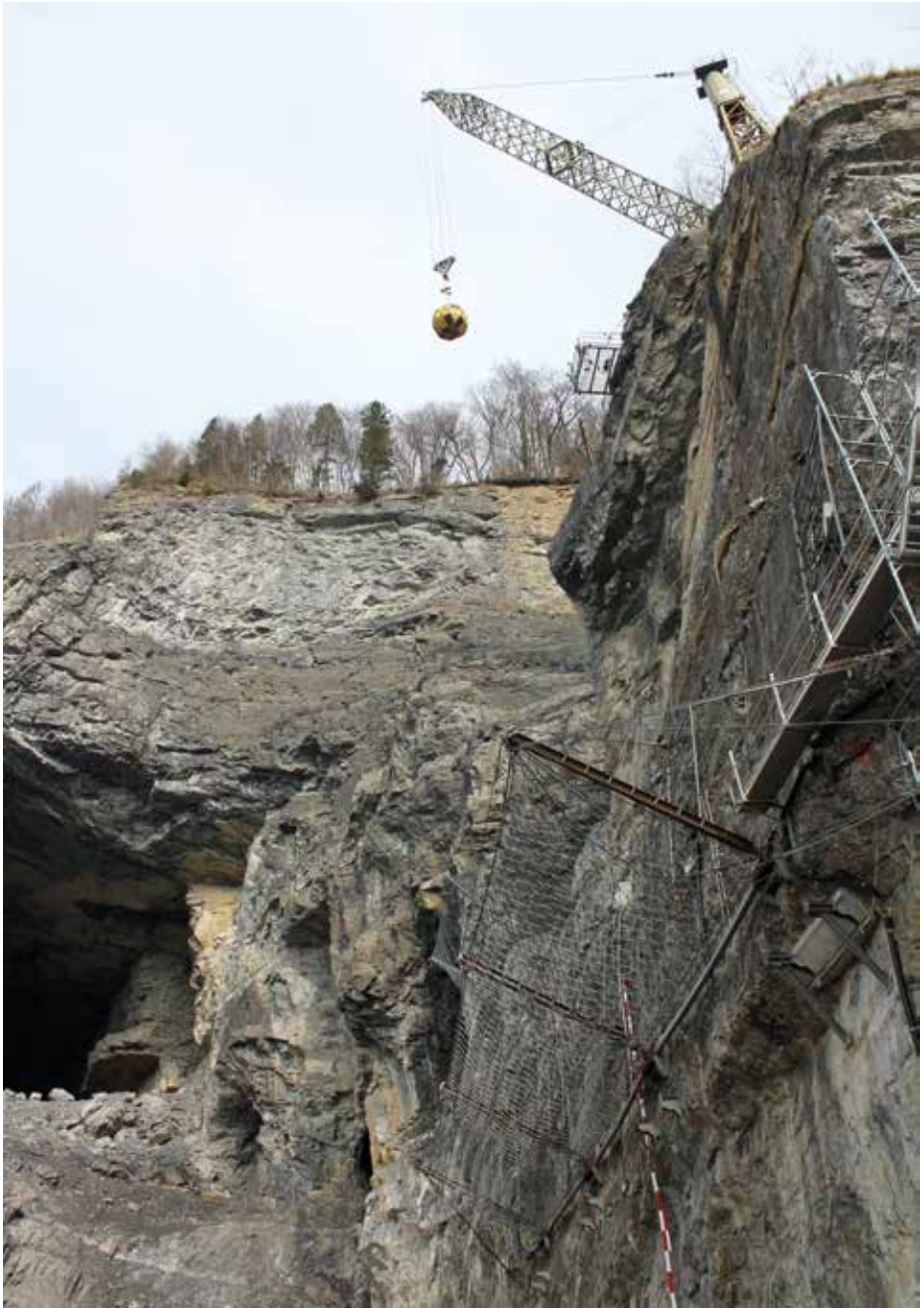
Kurz vor dem Fall: Der Kran hebt den acht Tonnen schweren Block gut 40 Meter übers Netz. (Bild: Bianca Guggenheim)
