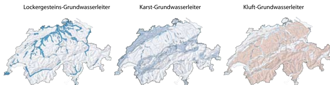
Abbildung 4: Verteilung verschiedener Grundwasserleiter in der Schweiz. 16
